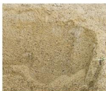
Foto 5.2 - Areia segundo a NBR 7211.
