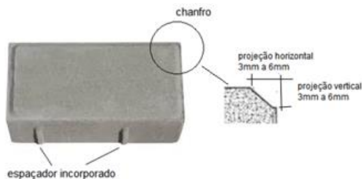
Figura 4.7 - Detalhe do chanfro e do espaçador de juntas do bloco de concreto conforme a ABNT NBR 15953.
