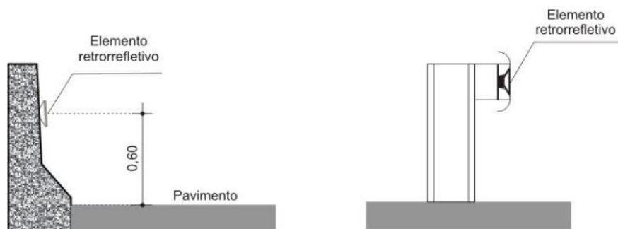
Figura 1.17 - Balizador refletivo de ponte, viaduto, túnel, barreira e defesa. Fonte: MBST. Vol. VII. CONTRAN 2017.
